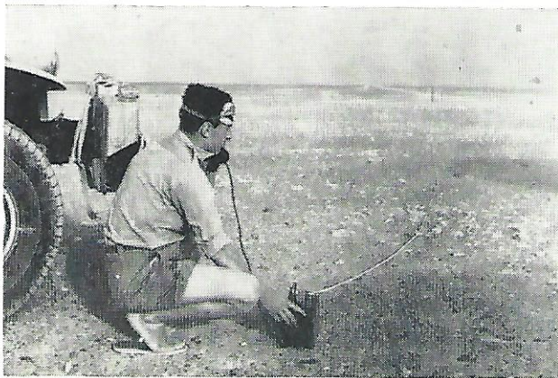
Seismisch onderzoek. Door een druk op de knop wordt een kleine lading dynamiet tot ontploffing gebracht.
