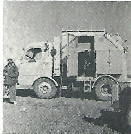
In de meetwagen worden de door de explosie in de aarde veroorzaakte trillingen geregistreerd.
